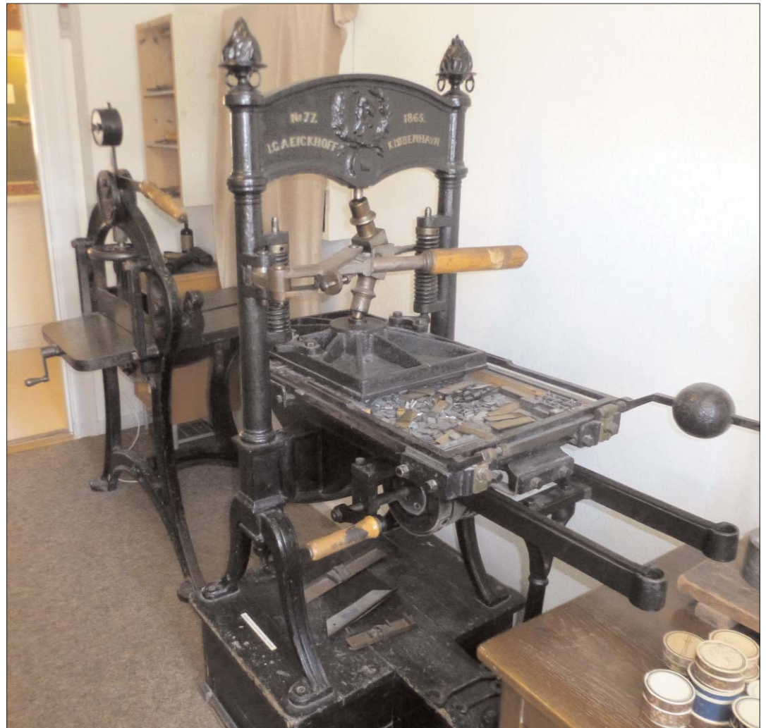
Den gamle trykpresse, fremstillet af I. G. A. Eickhoff, København 1865. Da trykkeriet først åbner i 1880'erne, må vi formode, at maskinen er købt brugt. Trykpressen er beregnet til korrekturtryk og man kan kun trykke en side ad gangen.
