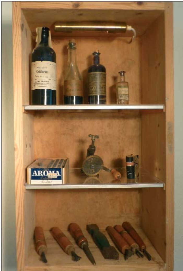
Fra bogbinderværkstedet ser vi på hylden foruden maskinskårne såkaldte "messingfileter" med forskellige mønstre, beregnet til prægning af bogryggen, almindeligvis med bladguld. På mellemste hylde er der til højre en tændstikæske, indbundet som bog. Øverst til venstre står en flaske med snitfarve til brug ved indfarvning af bogens tre snitflader.
